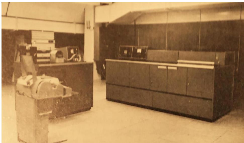
Urządzenie Linotron 505 Te przeznaczone do szybkiego składu fotograficznego.
