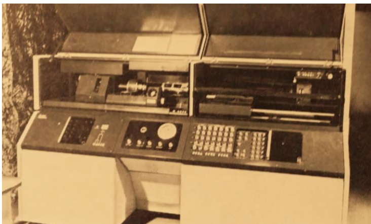
Magnascan 460 - urządzenie do elektronicznego wykonywania wyciągów barwnych z możliwością stosowania korekty poszczególnych kolorów.
