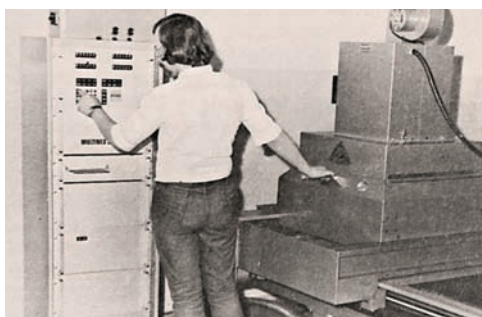
Sterowana przy pomocy programu maszyna do wielokrotnego kopiowania.
